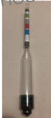
Anexo 7. Escala del hidrómetro
